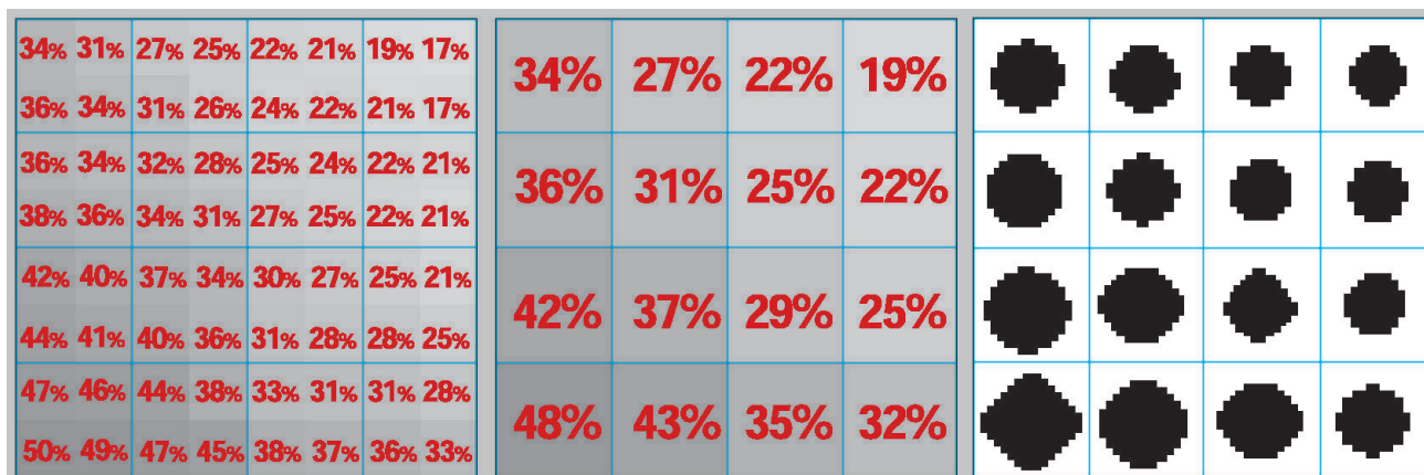
Figura 2: Se a imagem digital possuir uma quantidade de pixels por polegada maior que o número de pontos a serem gerados no filme (o dobro, no exemplo acima), o RIP faz uma média dos tons adjacentes para calcular o valor da retícula.
