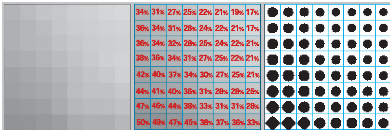
Figura 1: Ao gerar o fotolito, o RIP da imagesetter substitui os tons de cinza dos pixels digitais por pontos com área de cobertura equivalente, formando a retícula de impressão. No exemplo acima, a substituição é feita na proporção de 1:1.
